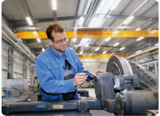
In der Werkstätte Ständlerstraße ist ein Mitarbeiter mit der Radreifenprüfung beschäftigt.
