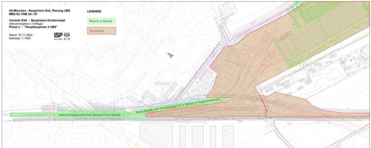
Abbildung 31: Bauphasen-Grobkonzept Variante GV6 – Phase 2 (Teilbetriebnahme neue Wendanlage des UBS, Hauptbauphase 2 für UBS; Errichtung Vorhaltemaßnahmen für Verlängerung U5)
