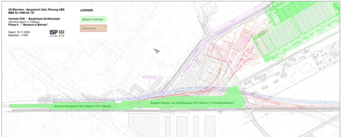
Abbildung 29: Bauphasen-Grobkonzept Variante GV6 – Phase 0 (Bestand in Betrieb)
