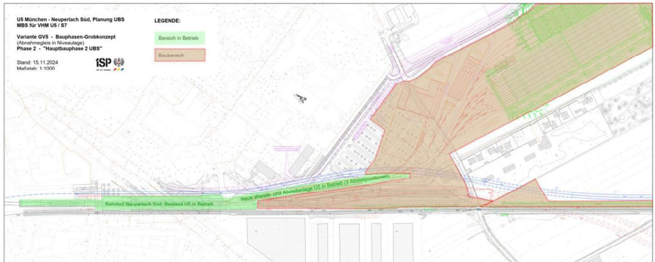
Abbildung 25: Bauphasen-Grobkonzept Variante GV5 – Phase 2 (Teilbetriebnahme neue Wendanlage des UBS, Hauptbauphase 2 für UBS; Errichtung Vorhaltemaßnahmen für Verlängerung U5)
