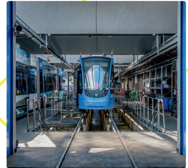
Arbeitsplatz mit Spezialperspektive: Blick in die Werkstatthalle des Tram-Betriebshofs Einsteinstraße, wo ein Avenio bereit zur Inspektion über der Grube steht.
